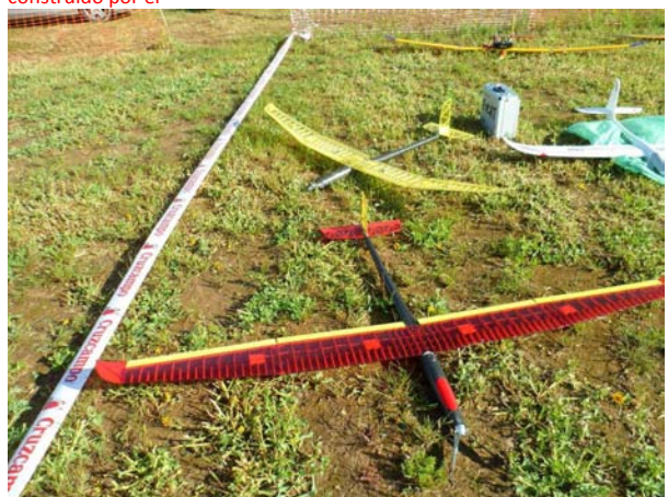
Dos de los modelos locales, diseñados por Antonio Jesús Duro y denominado 'Amysticia', con fuselaje de carbono y el larguero del ala de un tubo de carbono igualmente, el resto, balsa.
